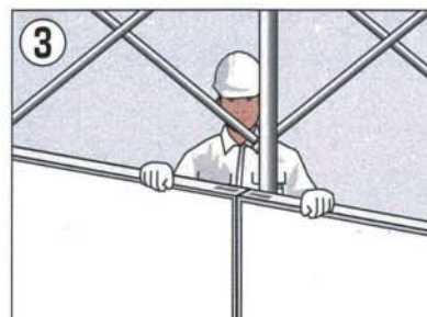
③ 上のクランプ孔をピタッと合わせる。
